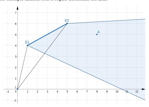
Logo, a solução consiste em saber se o ponto A está dentro dessa região. O espelho respeita as leis da física, que regem a reflexão da trajetória do laser ao bater no espelho ( $\theta_i = \theta_r$ ). Existem algumas formas de simular essa reflexão, é possível rotacionar a reta que representa a trajetória do laser, é possível rotacionar o espelho para que fique paralelo a um dos eixos coordenados, contudo são abordagens que exigem uma implementação mais complexa.
