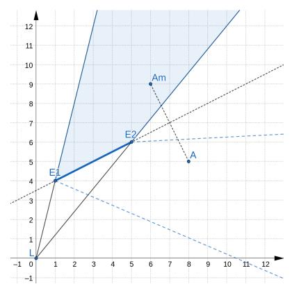
Para gerar a imagem virtual  $A_m$ , basta espelhar/refletir o ponto A em relação a reta do espelho de forma simétrica, utilizando da operação produto escalar. A partir do produto escalar é possível encontrar a projeção do ponto A na reta do espelho, com isso, utilizamos de soma e subtração de vetores para refletir o ponto para o outro lado da reta, centrado na projeção encontrada.
