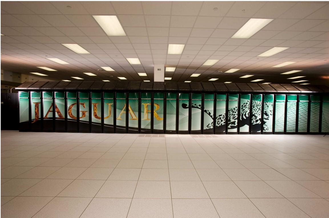
Figura 1.19: Cray XT5-HE Opteron Six Core 2.6 GHz, o computador mais rápido do mundo na lista TOP500 de 2009, instalado no *Oak Ridge National Laboratory*. Usa o processador AMD x86\_64 Opteron Six Core 2600 MHz de 10,4 GFlops e o sistema operacional Linux.
